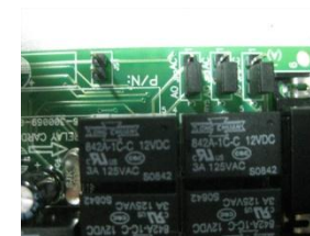
图 5 AO 与 AC 丝印显示 3-pin 连接器的状态
