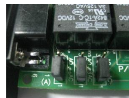
图 6 闭路状态的跳针设置
